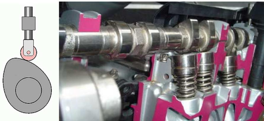
Figure.52. Système à cames, soupapes d'admission et d'échappement des gaz dans un moteur thermique.
